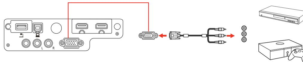
3. Serrez les vis du connecteur VGA.
