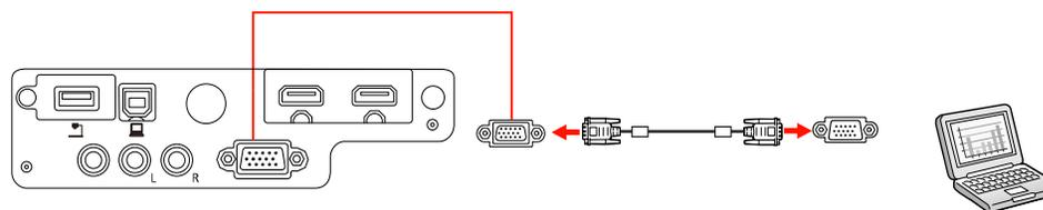
4. Serrez les vis du connecteur VGA.
